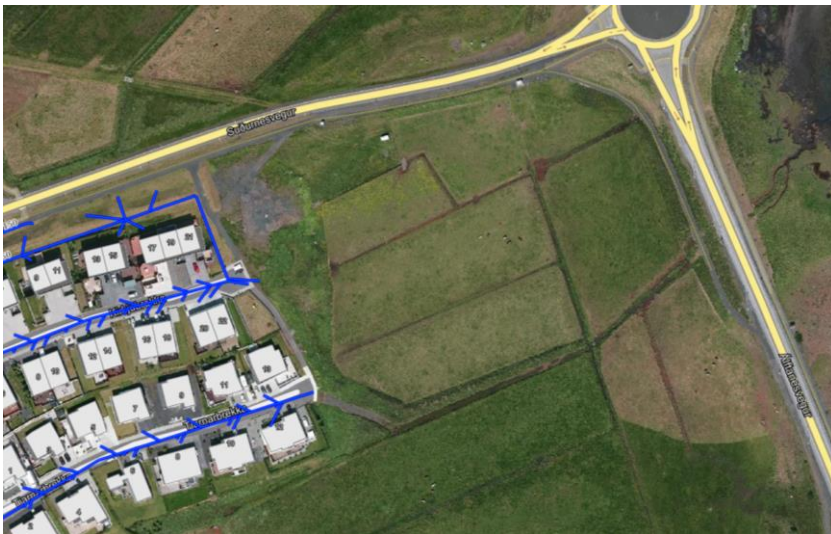
Mynd 3 Útrásir regnvatnskerfa Kirkjubrekku og Tjarnarbrekku.
