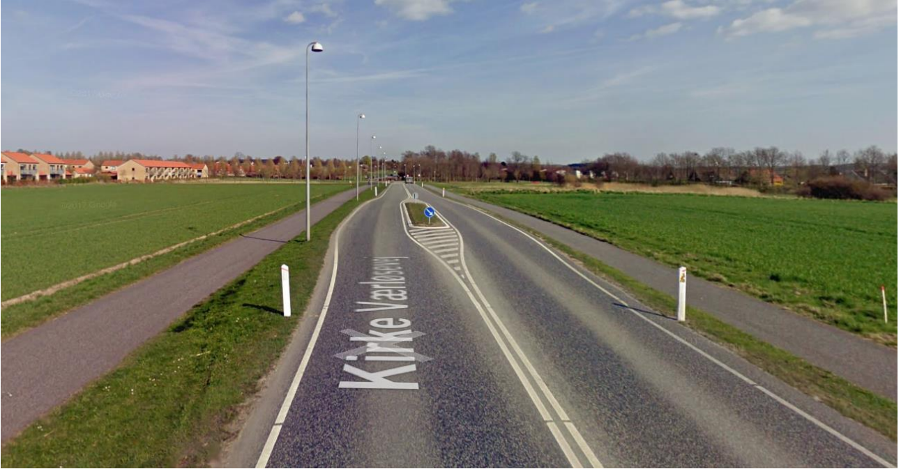
Mynd 8-4 Dæmi um miðeyju sem sett er á 50 km veg til að hægja á umferð áður en komið er að gatnamótum
